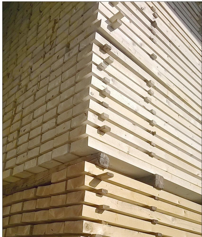
Ebenso wichtig wie die Stromeinsparung ist die deutliche Verbesserung der Trocknungsqualität. Durch den Wechseltrocknungszyklus neigt die Ware weniger zum Reißen, Schüsseln und Verdrehen als bei konventioneller F/A-Trocknung.
